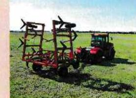
Основным рабочим органом культиваторов является плоскорежущая лапа. Плоскорежущие рабочие органы на раме орудия расположены в два ряда. На культиваторах серии КСТ ширина захвата лапы составляет 500 мм, серии КПП – 960 мм.
